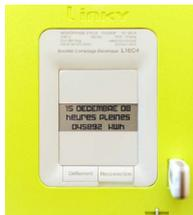
Linky est une **nouvelle génération de compteurs** avec un système d'information associé. Il permet de **recevoir des ordres et de transmettre des informations à distance**, sans intervention sur place d'un technicien.
